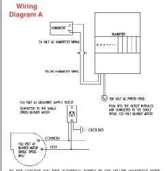
DO NOT CONNECT ANY TYPE ELECTRICAL POWER TO THE YELLOW HUMIDISTAT WIRES DO NOT CONNECT YELLOW HUMIDISTAT WIRES TO FURNACE CONTROL BOARD
